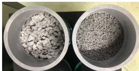
図1:PC(左:大碎石(Case1), 右:小碎石(Case2)) PC(Left:BigAggregate(Case1), Right:SmallAggregate(Case2))
